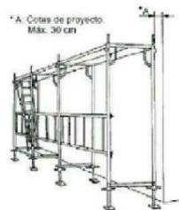
Montar el encadenado del andamio y comprobar su separación de la fachada de acuerdo con las cotas indicadas en el proyecto, que no deben superar los 30 cm.
