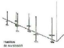
Colocar los husillos con placa en el terreno debidamente acondicionado empezando por el punto más alto y terminando en el punto más bajo
